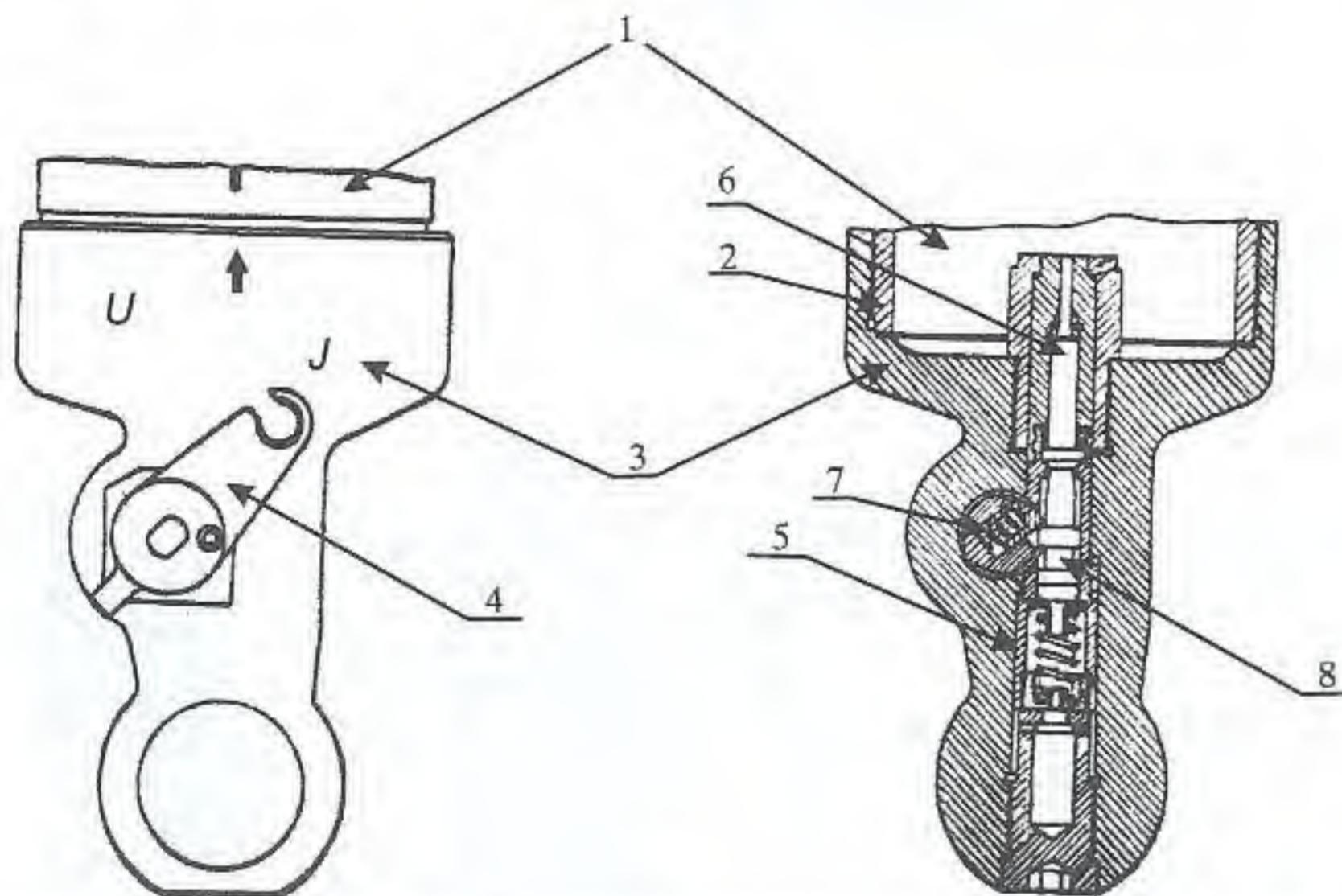
Слика 19. Положај делова механизма за запињање и окидање и механизма за опаљивање при јединачној пљбби
